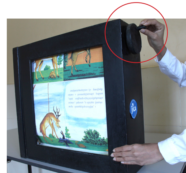
ឧបករណ៍ប្រអប់ទូរទស្សន៍មើលពីចំហៀង៖ មានដងសម្រាប់បង្វិលដើម្បីឱ្យផ្ទាំងសាច់រឿងមានចលនាពីក្រោមទៅលើ
